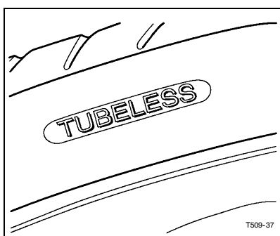
Marquage caractéristique d'un pneu
