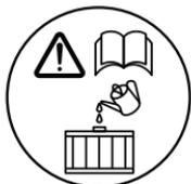
Pour assurer le rendement du refroidissement du moteur, contrôlez le niveau de liquide chaque jour avant de prendre la route, et faites l'appoint si le niveau est bas.
