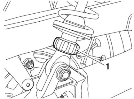
1. Réglage de détente de suspension arrière
