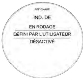
Le seuil de régime moteur peut être défini et réinitialisé et l'indicateur de changement de vitesse peut être désactivé. Une fois le moteur rodé (après 1 000 miles), l'option Running In (rodage) est remplacée par une option default (par défaut).
