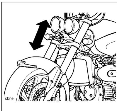
Examinez chaque jambe de fourche en recherchant des dégâts, des éraillures de la surface de coulissement, ou des fuites d'huile. Si des dégâts ou des fuites sont constatés, consultez un concessionnaire Triumph agréé. Vérifiez la douceur de fonctionnement de la fourche :
