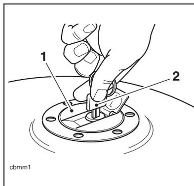
**1. Bouchon de réservoir de carburant**
