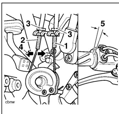
1. Dispositif de réglage du câble d'ouverture
