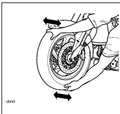
Si les roulements de roue avant ou arrière causent du jeu dans les moyeux, sont bruyants, ou si la roue ne tourne pas régulièrement, faites contrôler les roulements de roues par votre concessionnaire Triumph agréé.
