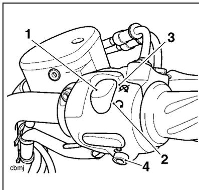
1. Interrupteur d'arrêt du moteur
