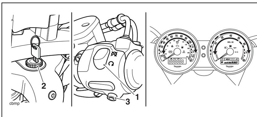
1. Interrupteur d'arrêt du moteur
